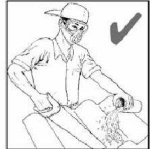
Realice los cortes y perforaciones de lámina mojando previamente las zonas de corte.
